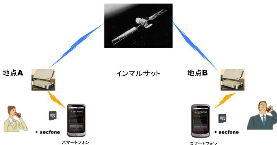
図表 8 テザリングを利用したスマートフォンによる衛星通信システムのイメージ
